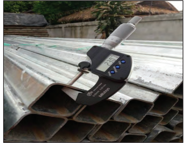
รูปที่ ๔.๑๕ การเก็บกองเหล็กทราวงันตกและตรวจวัดความหนา
